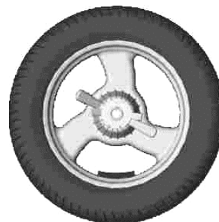
Рисунок 6.11 – Установка ленточных грузов
