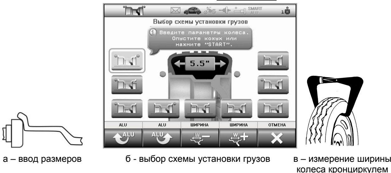
Рисунок 6.2 - Ввод параметров стандартного колеса
