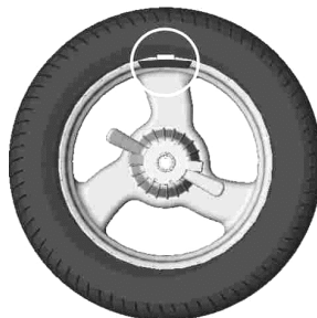
Рисунок 6.3 – Груз установлен в положение «12 часов»
