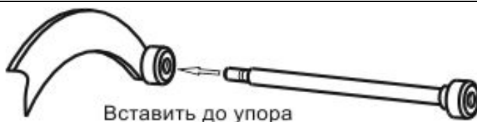
Рисунок 7.6 – Использование удлинителя линейки
