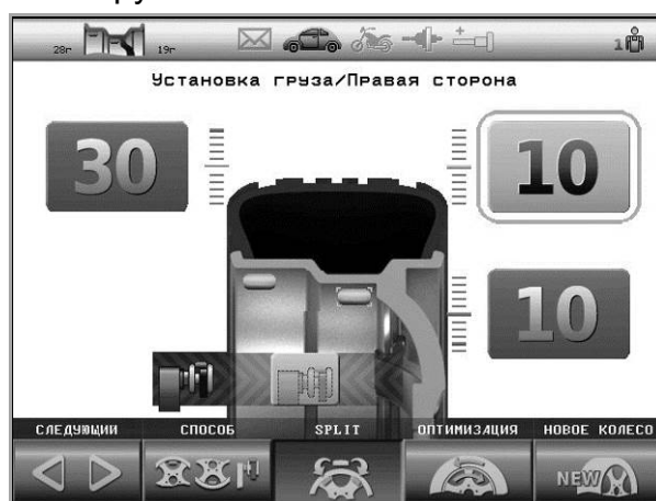
Рисунок 7.5 – Экран установки грузов в режиме Split
